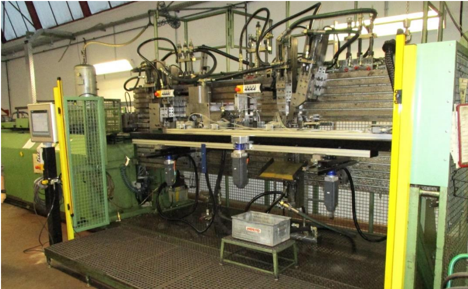
Nach dem Retrofitting mit Servotransfer und aktueller Sicherheitstechnik (Fotoinweis: Schmale Maschinenbau)
